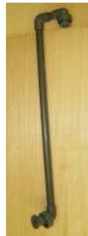
Figura 22: Conector del Clorador de Pastillas
