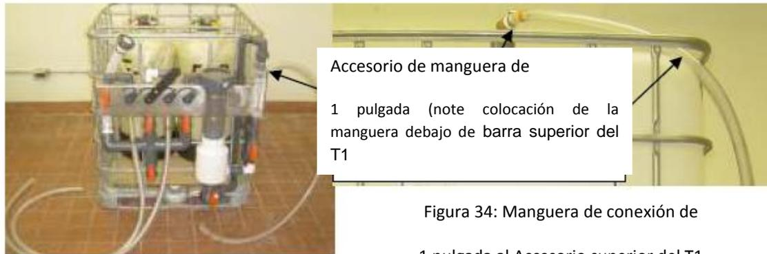
Figura 33: Manguera de 1 pulgada hacia el ensamblaje de la válvula
