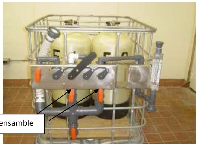
Figura 18: Válvula de ensamble con el colector de Turbulencia.
