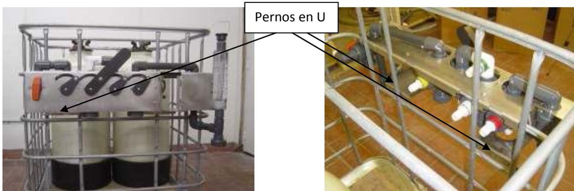
**Figura 11: Posición del Ensamblaje de Válvulas**
