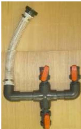
Figura 15: Colector de Turbulencia.
