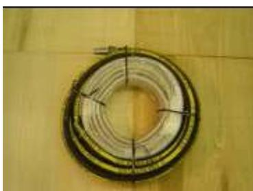
Figura 3: Manguera de succión de 1.5 pulgadas y manguera trenzada de 1 pulgada
