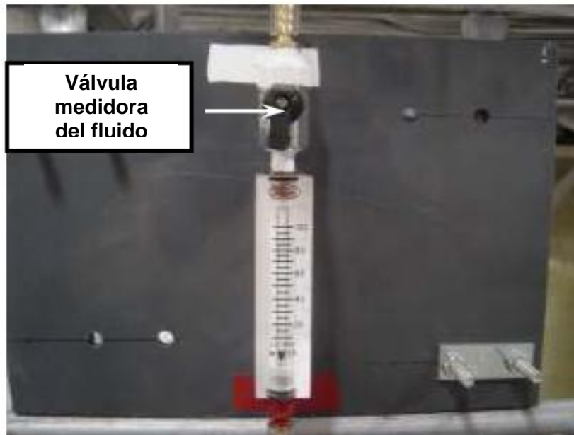
Figura 3: Válvula medidora de fluido en el colector controlador del flujo de aluminio.
